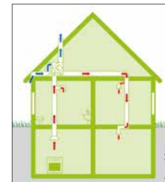
Zentrale Lüftungsanlagen beugen Schimmelbildung vor und sind energieeffizient
