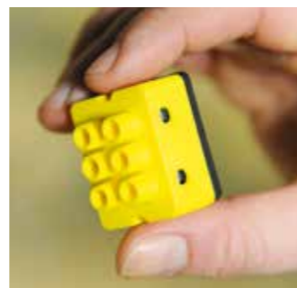
Die intelligente Lüsterklemme ist das Herzstück des Systems und wird in elektrische Geräte eingebaut
